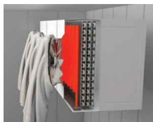
Figure B : Le conduit en tissu couvre l'unité lorsque le système est en cycle de dégivrage, empêchant la chaleur de s'échapper de l'unité.
